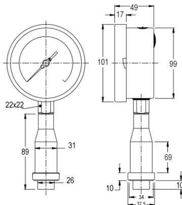
Присоединение в виде накидной гайки G1 ¼ (F)
